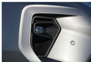
Projecteurs anti-brouillard avant à LED avec technologie Cornering light [1]
