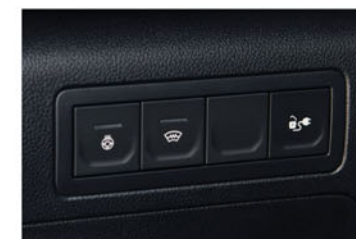
Commutateurs de chauffage [1]
